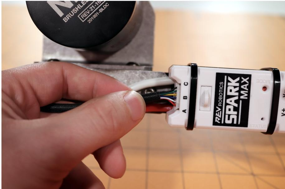
⚠ O cabo do sensor do encoder é necessário para o controle de motores sem escovas com SPARK MAX. O motor não vai girar sem ele.
