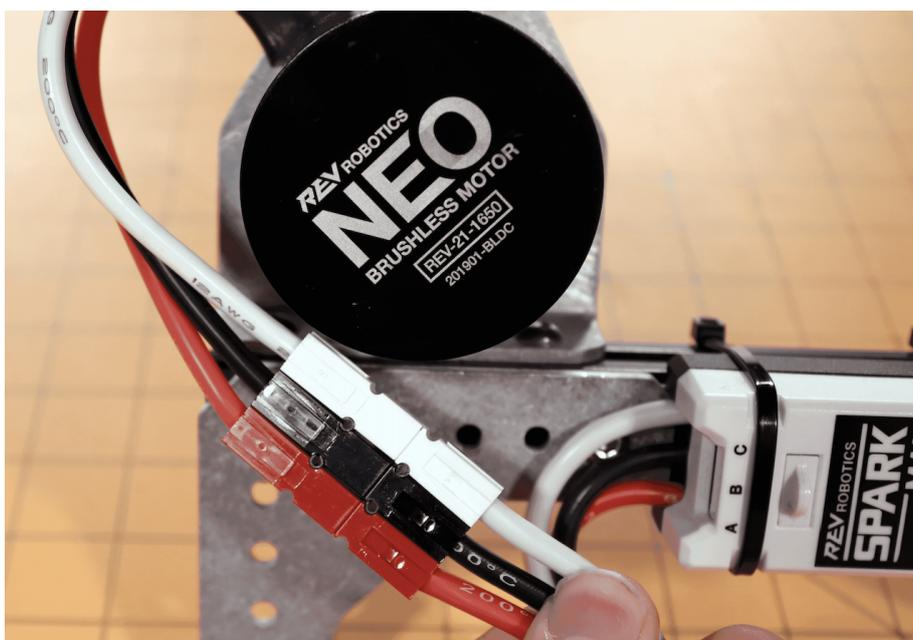
Em seguida, conecte o cabo do codificador do NEO ou NEO 550 à porta identificada como ENCODER logo acima dos fios de saída.
