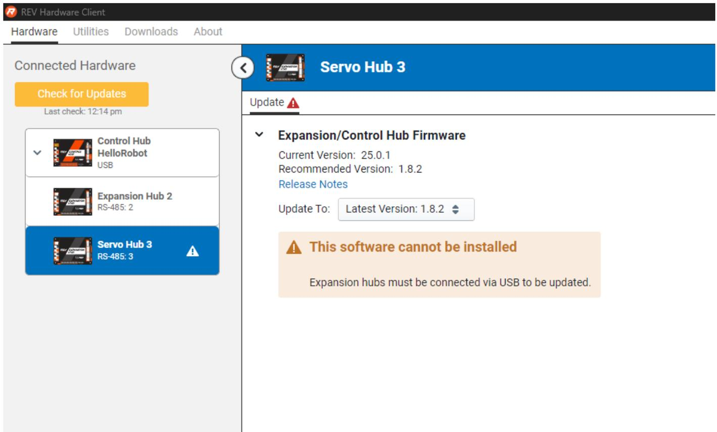
Esse é o comportamento esperado a partir da versão 1.7.0 do RHC. Para atualizar o hub de servo, desconecte-o do hub de controle e desligue-o antes de conectar apenas o hub de servo via USB-C.
