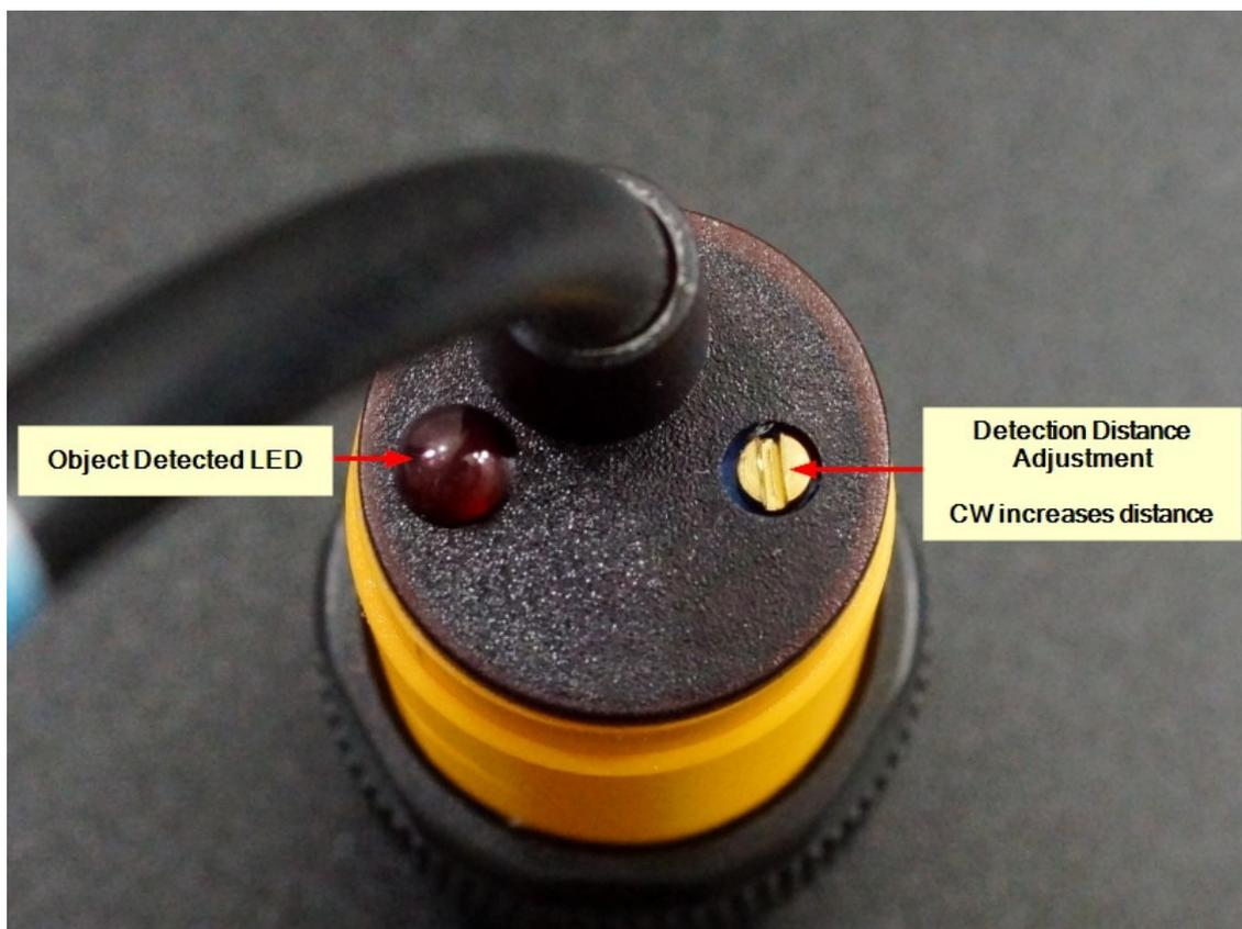
A parte de trás do sensor possui um parafuso, caso esse seja rotacionado no sentido **horário** a distância útil do sensor aumenta, agora, se o girarmos para o sentido **anti-horário** a distância de detecção diminui.
