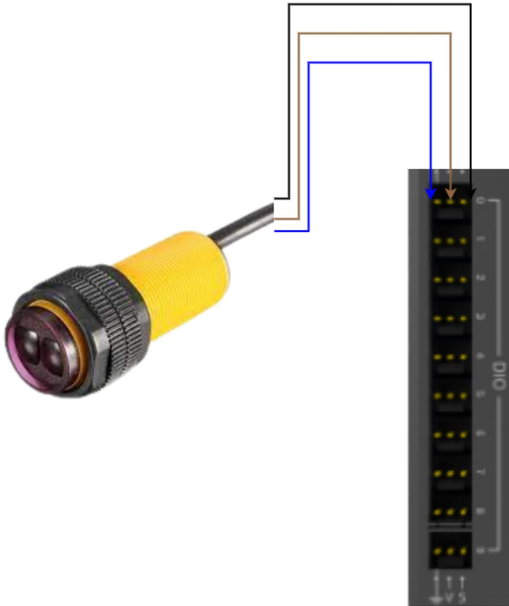
A vantagem deste sensor é que é possível conecta-lo diretamente ao roboRIO sem optoacopladores ou outros componentes.
