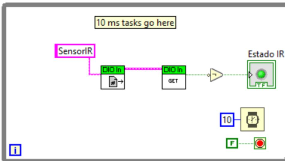
Se estiver utilizando um sensor ED30-D80B4 é possível inverter a leitura no próprio sensor, para isso de uma olhada na página [1.3 Calibração do sensor](#)
