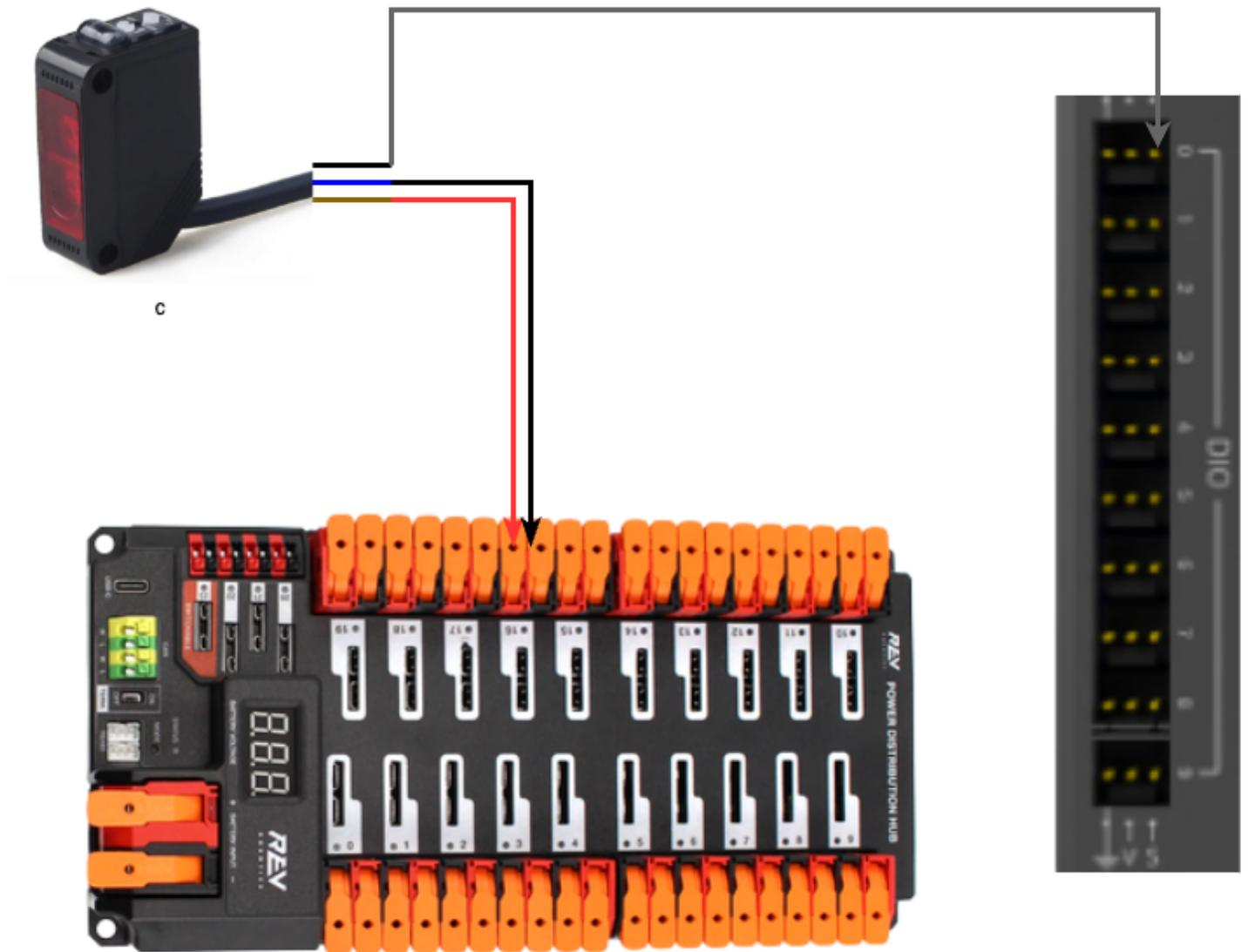
Importante notar que como o sensor utilizado é **PNP**, a carga - **optoacoplador** - deve ser conectada ao **GND** junto do sensor IR, como mostram os dois diagramas acima.
