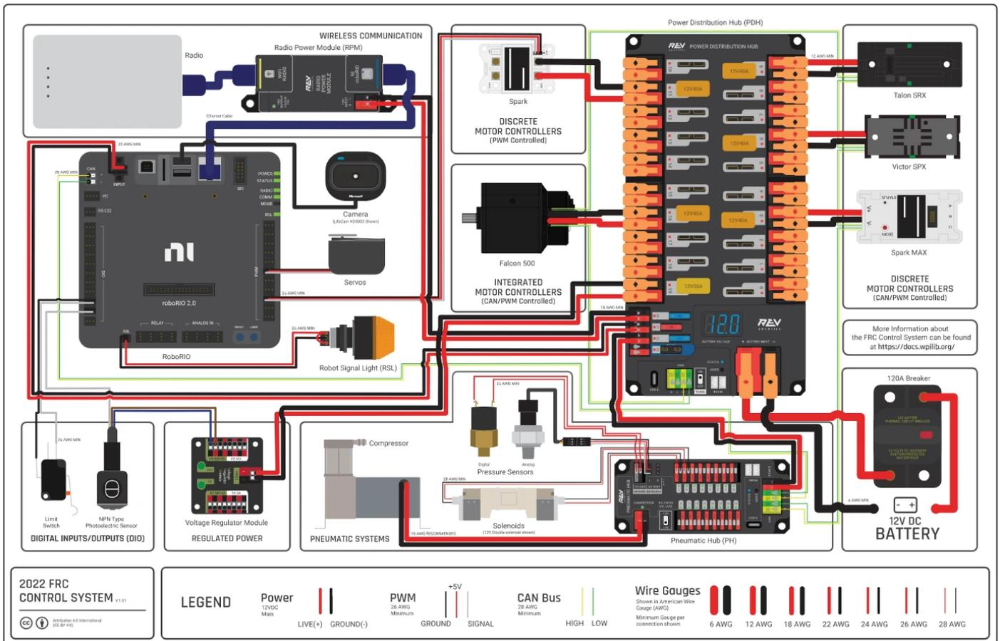
Certifique-se sempre de que o hub de distribuição de energia esteja desconectado de qualquer fonte de alimentação antes de adicionar ou modificar conexões.
