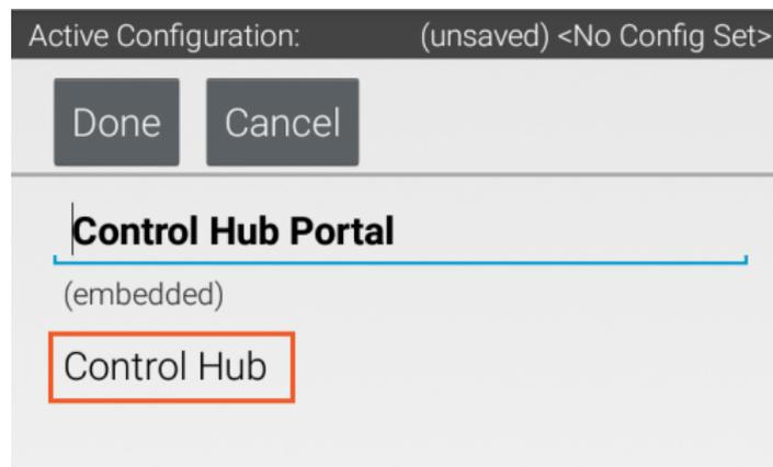
Isso o levará para a página mostrada na imagem. A partir daqui, você pode configurar motores, servos e sensores que está usando. Siga o restante do guia para descobrir como configurar dispositivos que serão usados na seção de Teste.
