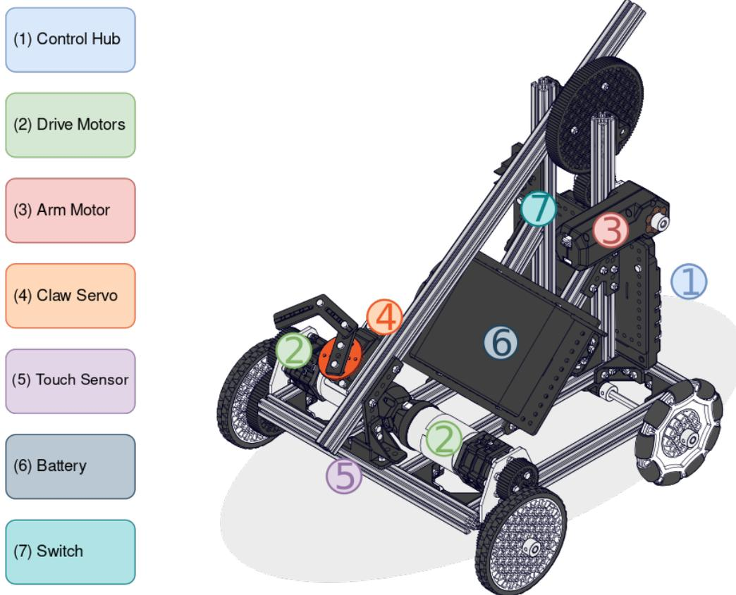
A seção de Configuração do Olá Robô concentrou-se na configuração dos componentes no Test Bed. Para avançar nas seções de programação do Controle do Robô, é necessário criar um novo arquivo de configuração para os componentes no robô. É sua escolha quais nomes de variáveis você deseja atribuir ao seu robô, mas, para referência, este guia usará os seguintes nomes para cada componente de hardware.
