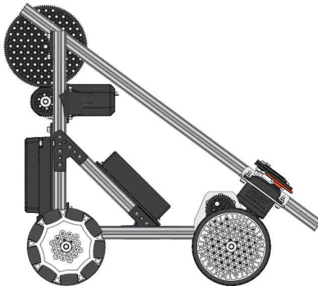
Controlar um braço requer um processo mental diferente daquele que você usou para controlar o drivetrain. Enquanto o drivetrain usa o movimento de rotação dos motores para percorrer uma distância linear, um braço gira em torno de um ponto central, ou junta. Ao trabalhar com um braço, você precisará ter cautela com as limitações físicas do robô, incluindo capacidade de carga, amplitude de movimento e outras forças que possam ser aplicadas.
