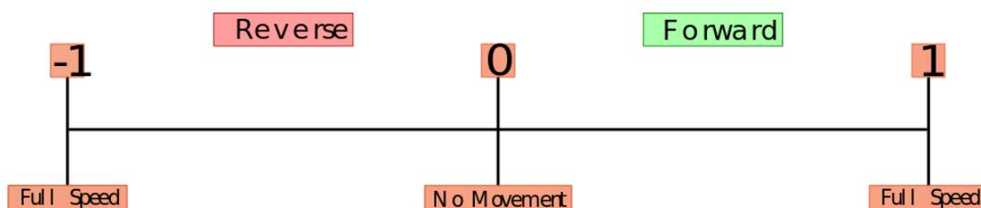
Quando um motor recebe um valor de `setPower` entre -1 e 0, o motor girará na direção que considera ser reversa. Quando um motor recebe um valor entre 0 e 1, ele girará para frente.
