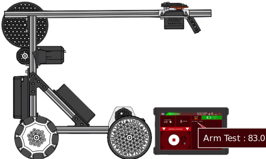
Recordem-se da seção [Conceitos Básicos de Encoder](#), na qual a posição do encoder é definida como 0 cada vez que o Control Hub é ligado. Isso significa que, se o braço estiver em uma posição diferente da posição inicial quando o
