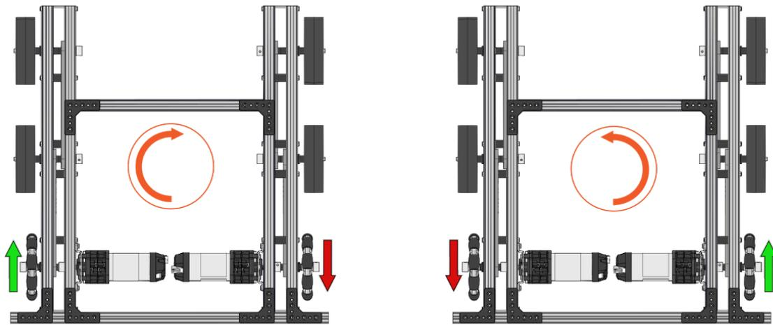
Para a classe Bot, em que o robô pivota para a direita, o motor direito será invertido. Adicione a linha `rightmotor.setDirection(DcMotorSimple.Direction.REVERSE);` ao `op mode`, logo abaixo das declarações de variáveis.
