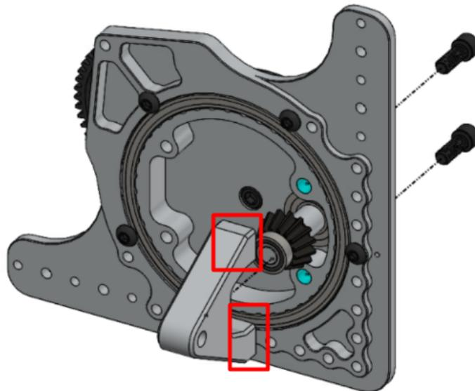
Cuidado com a ordem dos componentes e tamanho dos espaçadores na hora de acoplar nos eixos, se atentem quanto ao posicionamento e orientação dos componentes.
