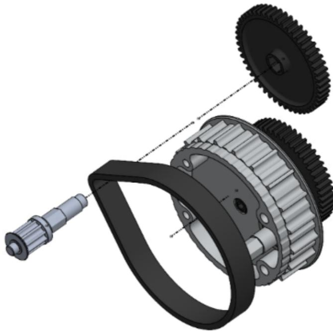
Após a montagem do conjunto na chapa, cuidados na inserção do pinhão cônico na parte inferior, pois ambos os lados não estão fixos, e com a rotação da montagem pode ser que as se soltem, conforme indicado pelas setas em azul.
