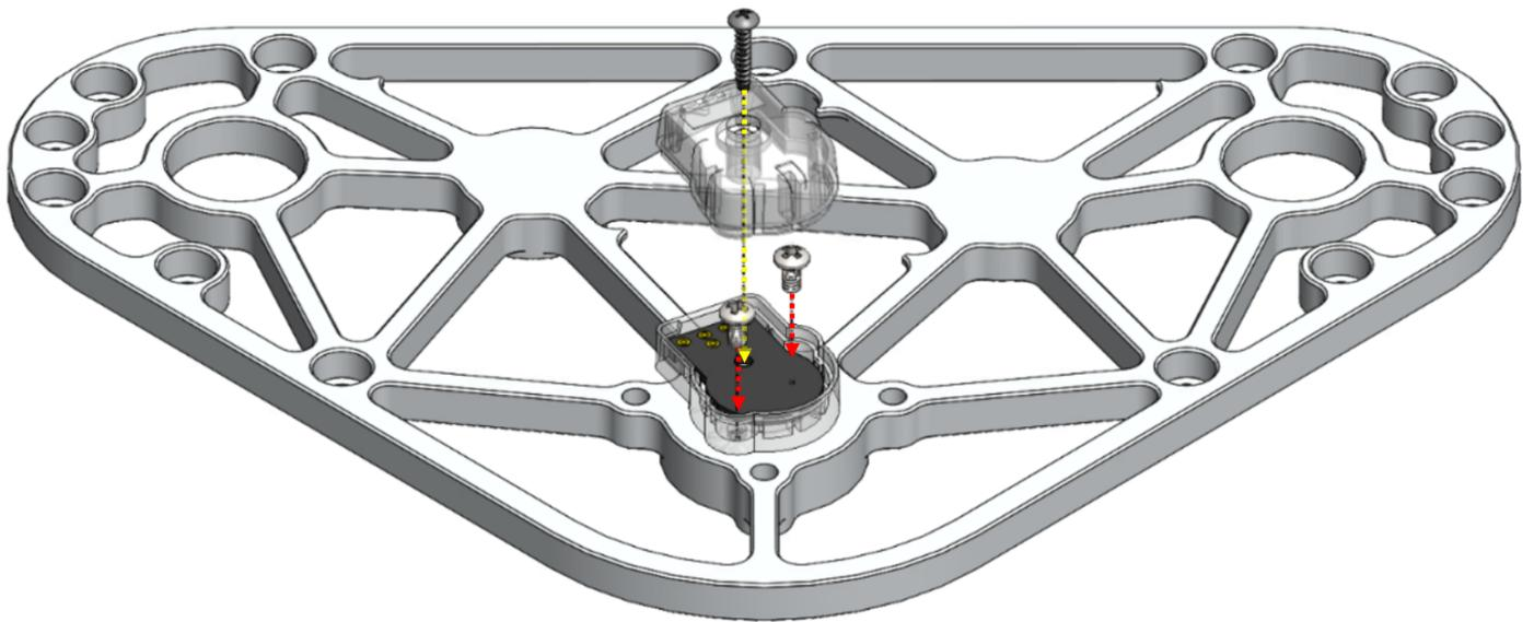
Não aperte os parafusos além do necessário, pois pode resultar em danos permanentes ao encapsulamento do encoder. Apenas com a força manual até sentir resistência
