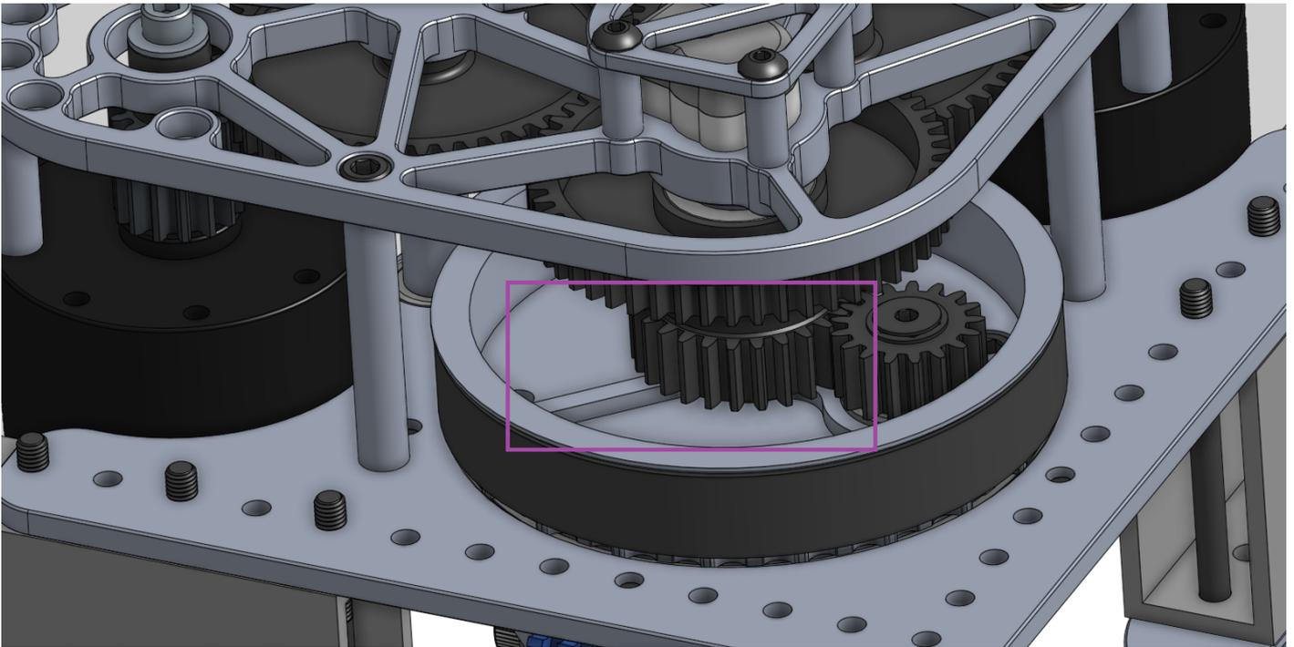
4. Ainda com as chaves de fenda, retire a sujeira das engrenagens conicas e da parte interna da roda
