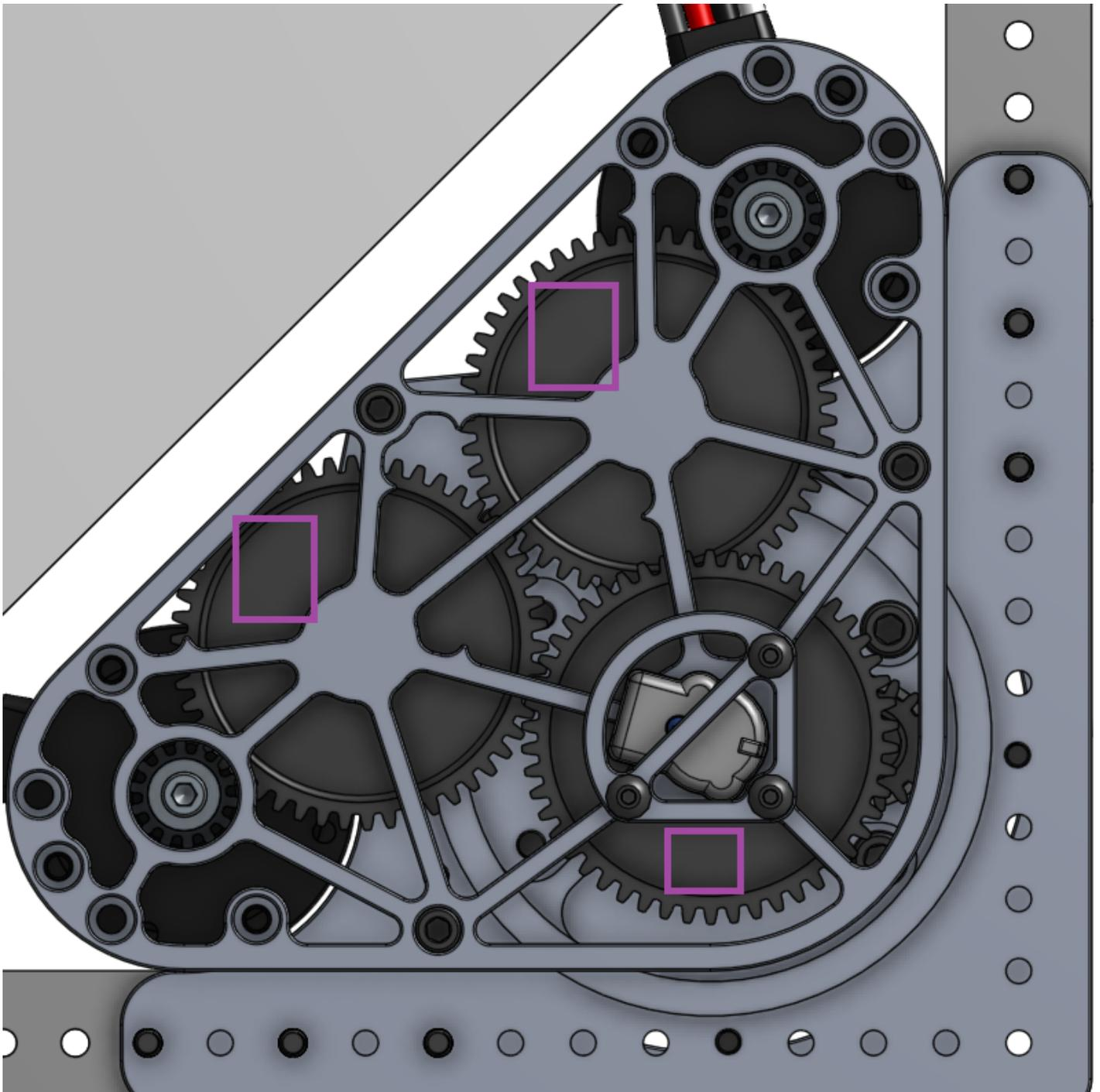
2. Aproxime a chave de fenda dos pontos de interseção das engrenagens e gire a roda para remover o excesso de graxa
