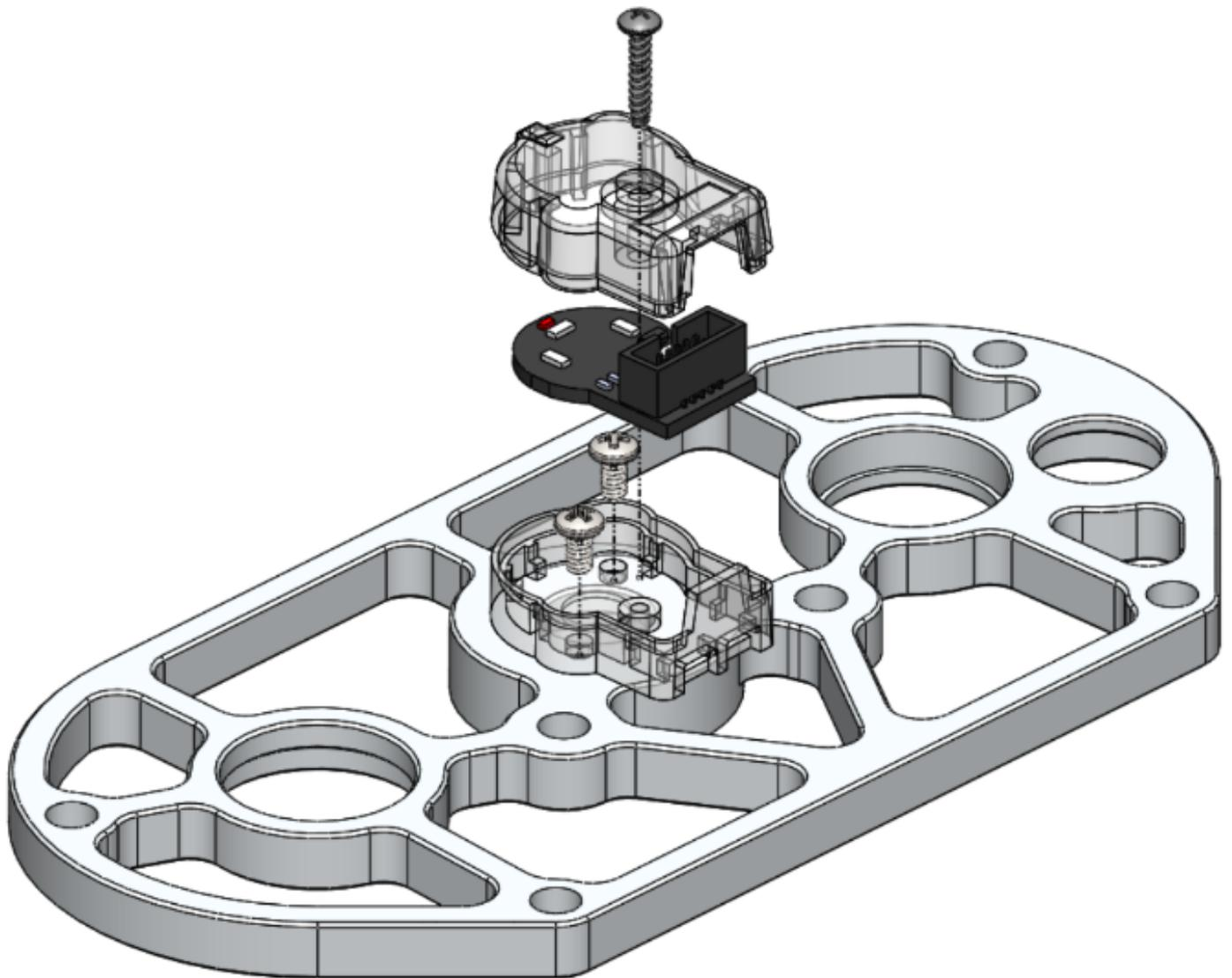
**NÃO APERTE OS PARAFUSOS ALÉM DO NECESSÁRIO, POIS PODE RESULTAR EM DANOS PERMANENTES AO ENCAPSULAMENTO DO ENCODER. APERTE APENAS COM A FORÇA MANUAL ATÉ SENTIR RESISTÊNCIA**
