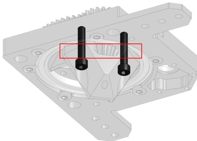
Quando for inserir os parafusos, atente-se que os parafusos devem ficar levemente soltos, para as montagens posteriores
