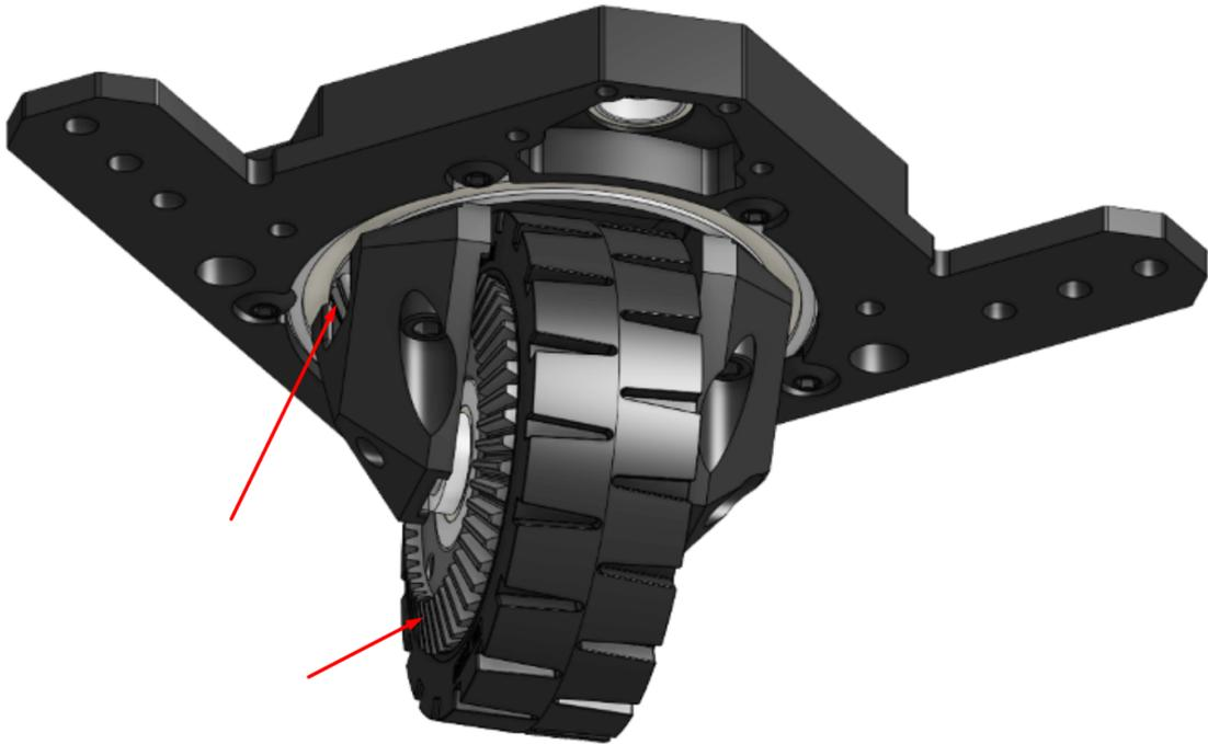
Coloque o parafuso no eixo da roda e deixe levemente solto. Aperte os parafusos dos garfos e posteriormente aperte o parafuso do eixo da roda. Cuidado para não apertar os parafusos além do suficiente!
