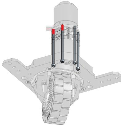
Após a inserção dos parafusos com a cola, remova os parafusos sem cola e aplique cola.
