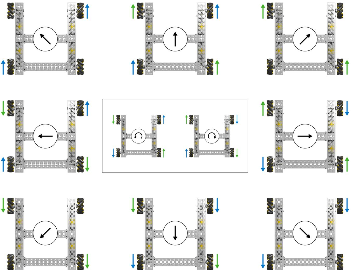
As rodas Mecanum permitem manobrar em todas as direções. Para conseguir isso, as rodas precisam ser controladas de uma forma específica. As setas verdes representam a rotação das rodas inclinadas esquerdas. As setas azuis representam a rotação das rodas inclinadas direitas. Para avançar, lateralmente ou diagonalmente, as rodas inclinadas esquerdas movem-se juntas e as rodas inclinadas direitas movem-se juntas. No entanto, para girar os estilos de direção deslizante,
