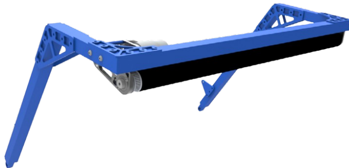
Mecanismo de coleta do robô Barrage, retirado da equipe de FRC The Cheesy Poofs, 254.
