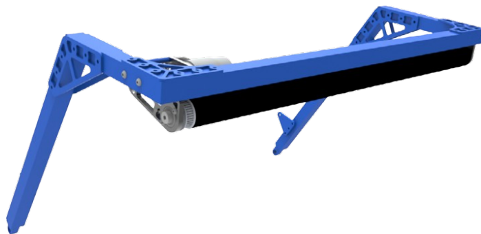
Mecanismo de coleta do robô Barrage, retirado da equipe de FRC The Cheesy Poofs, 254.
