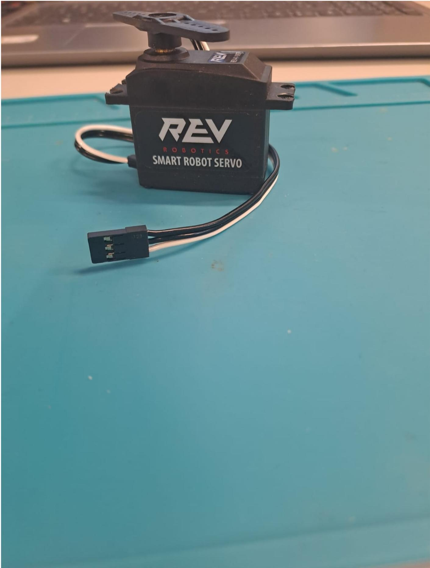
Quanto a conexão na placa EasySTEAM, é necessário verificar quais pinos correspondem ao terminal de saída do servo - para não acabar invertendo sinal com GND por exemplo. Mas visto isso, já é possível conectar, como seguem as demonstrações abaixo:
