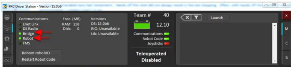
Usando o software da Estação do Condutor, clique em Diagnóstico e confirme que as luzes de Enet Link (ou luz do Rádio do Robô, se estiver operando sem fio) e as luzes do Robô estejam verdes.
