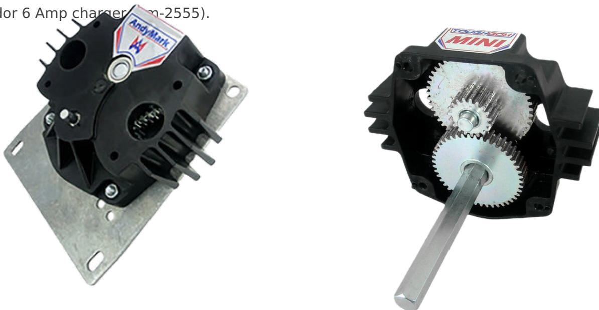
O Kit of Parts Chassis inclui duas [Toughbox Mini](#) que é a caixa de redução para a tração. A redução da caixa é 10.71:1 e, se utilizada com as rodas de 6" e 2 motores CIM fornecidos no kit, resultam em uma velocidade na roda de 4m/s, ou 12.98 ft/s como é comumente utilizado na FRC. O que vai proporcionar uma ótima relação entre velocidade e torque para o seu robô.
