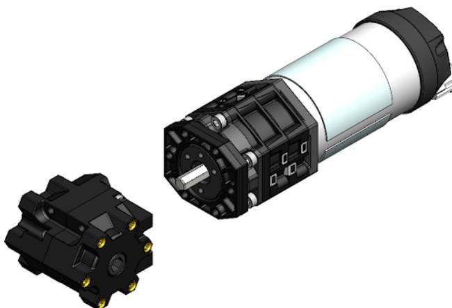
4) Deslize as duas caixas de redução até encaixarem. Rotacione a caixa de redução Ultra 90° até que o espaçador até o espaçador e corpo da caixa de redução estejam alinhados.
