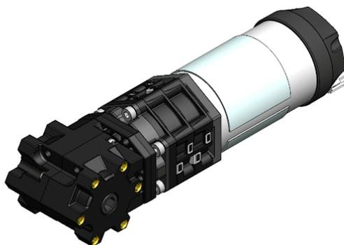
5) Insira os 4 parafusos de montagem nos furos na extremidade da caixa de redução Ultra 90°. Garanta que eles estejam alinhados com os furos do espaçador e da caixa de redução.
