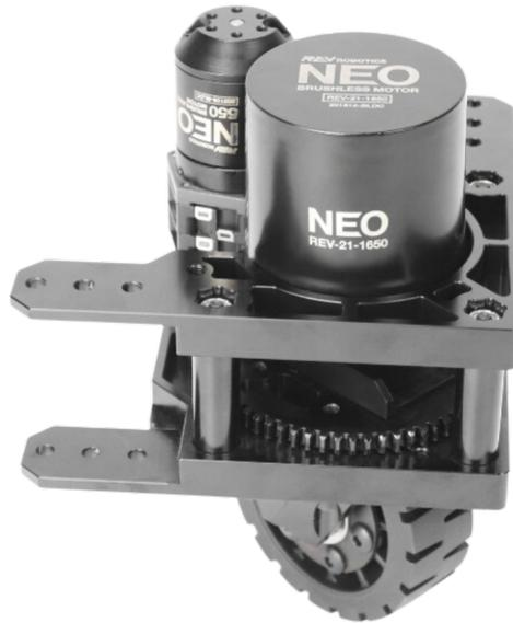
Na primeira imagem o motor está instalado em um módulo swerve, responsável pela tração do robô.
