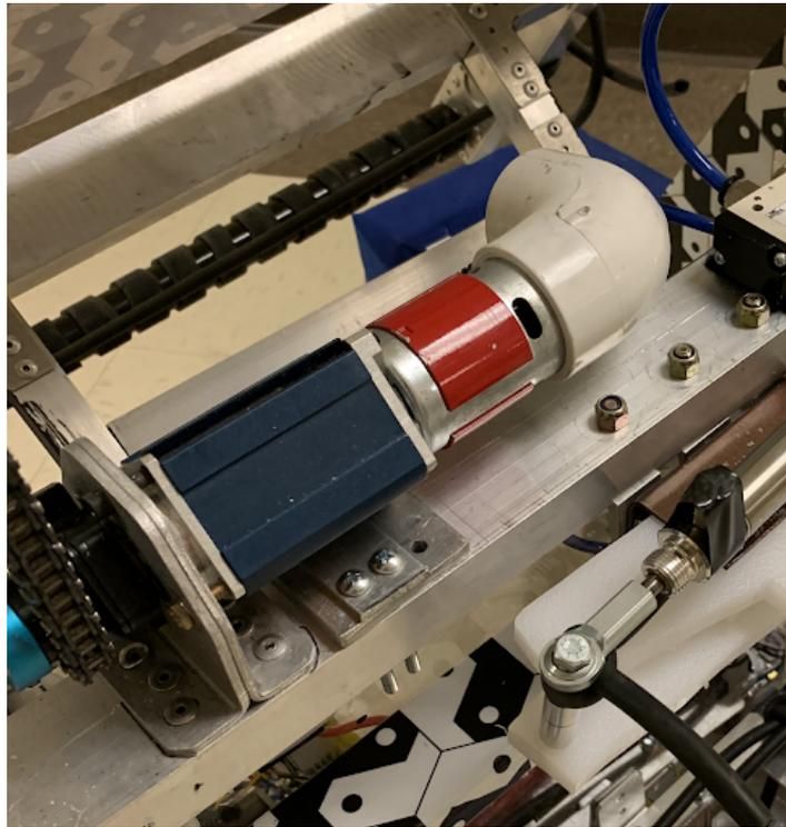
RedLine com uma Sport Gearbox 4:1 usada na temporada de 2020 pela equipe Under Control em seu atirador para tracionar um rolete. Para acessar o documento de como montar a caixa de redução e acoplar o motor (RedLine) [clique aqui](#).
