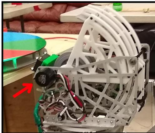
Nesta segunda imagem, ele está como principal atuador no sistema de atirar bolas de um robô projetado para o ano de 2022, acelerando a roda principal.
