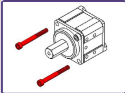
2. Remova o bloco de entrada do motor e a arruela de pressão de aço. Coloque a arruela de pressão de lado em um papel toalha.
