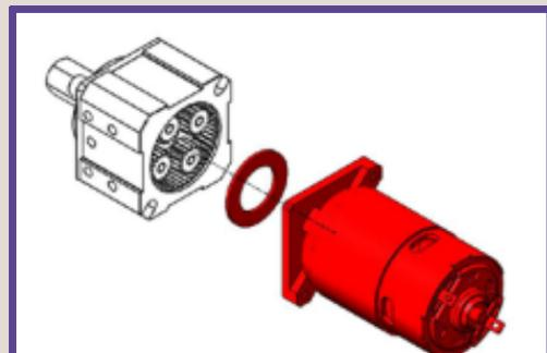
6. Depois que a caixa de redução estiver montada, reinstale os dois parafusos 10-32x1,75.
