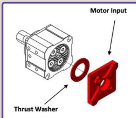
3. Conecte o bloco ao Motor RedLine usando parafusos M4-0.7 e arruelas de pressão.
