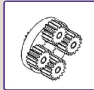
5. Reinstale a arruela de pressão e insira o motor, gire o eixo de saída para lubrificar as engrenagens.
